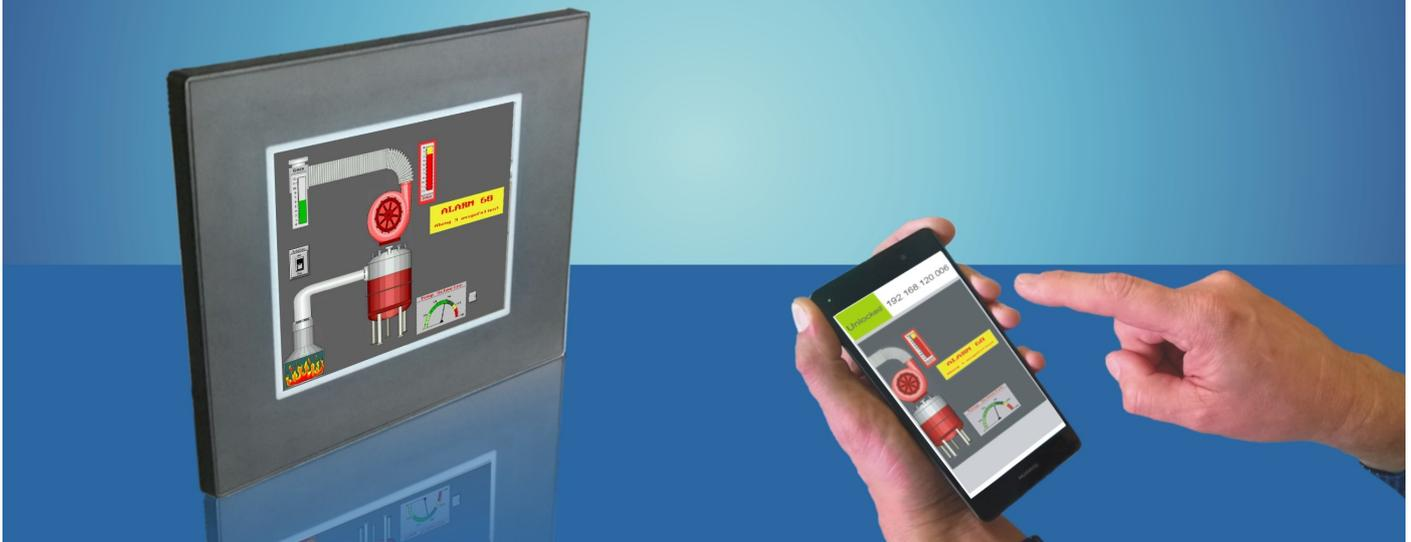
Mit dem EZ3-Touch präsentiert UTICOR Automation die dritte Generation einer vollgraphikfähigen Bedienstation, die von **Allen Bradley**, über **Modicon/Schneider Electric** bis hin zu **Siemens** an die einschlägigen Systeme anbindbar ist. Neben der klassischen Anbindung über eine **RS232**-Schnittstelle gehört die Kommunikation über **Ethernet** zum Standard.
